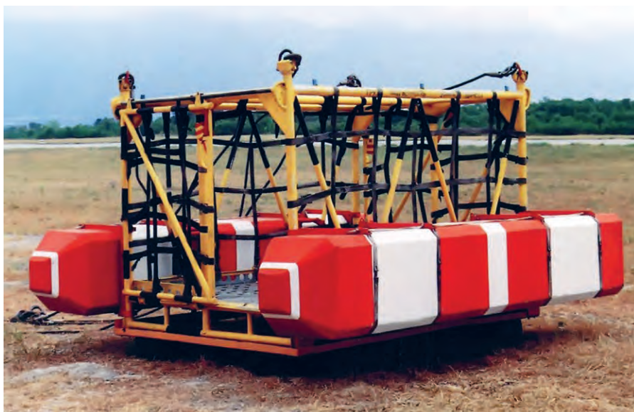
Рис. 2.6.1. Транспортно-спасательная кабина на 20 человек
