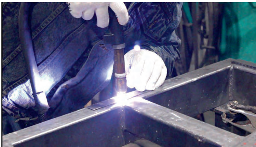
Рис. 13.8.2. Дуговая точечная сварка методом проплавления
