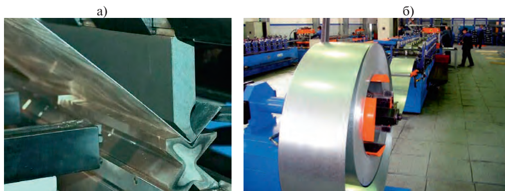
Рис. 3.2.1. Технологии изготовления тонкостенного профиля: а — гибка на стане; б — профилирование на механизированной линии.
