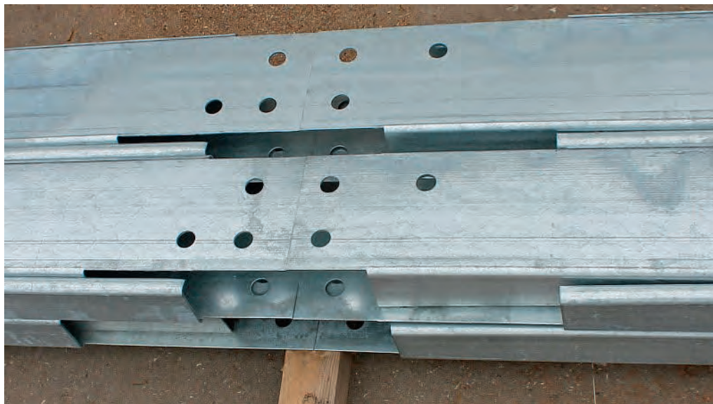
Рис. 9.5.16. Готовые к сборке детали каркаса из ЛСТК-профилей.
