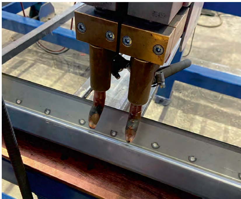
Рис. 13.8.3. Электроконтактная сварка двумя электродами
