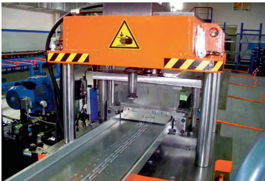
Рис. 3.2.6. Изготовление просечного термопрофиля
