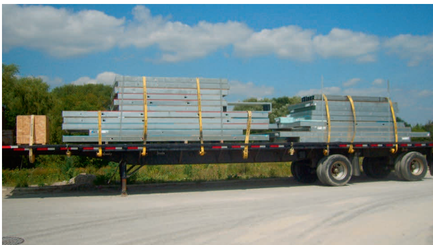
Рис. 11.1.5. Транспортировка панелей стен и перекрытий на строительную площадку
