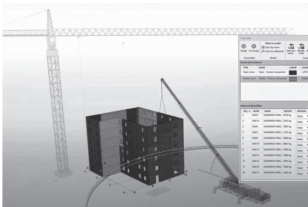
Рис. 17.4.3. Расположение строительной техники в информационной модели
