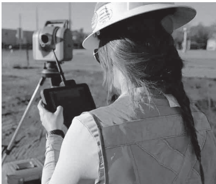
Рис. 17.4.4. Работа геодезиста (комбинированный сканер-тахеометр)
