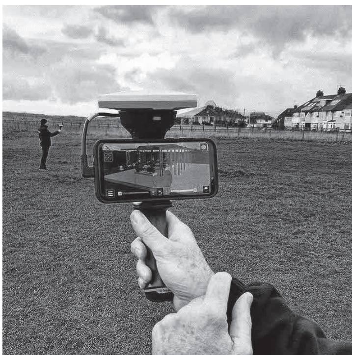
Рис. 17.4.5. Портативный визуализатор моделей
