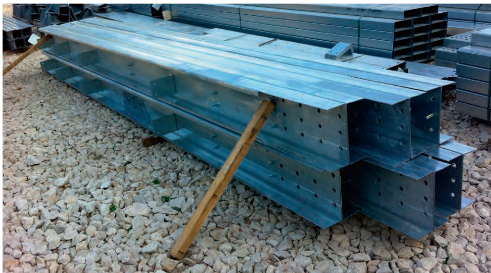
Рис. 9.5.17. Составные колонны из С-образных холодногнутых оцинкованных профилей
