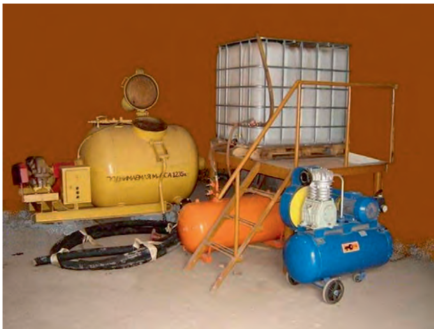
Рис. 12.3.7. Установка для приготовления пенобетона
