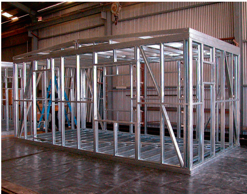
Рис. 11.1.11. ЛСТК модульного комнатного блока
