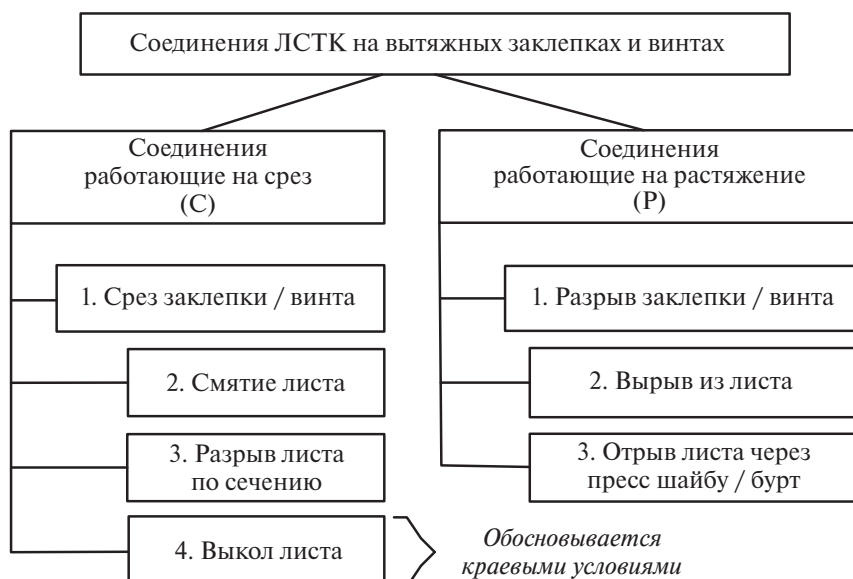
Рис. 13.3. Схема типов отказа соединений ЛСТК на вытяжных заклепках и винтах
