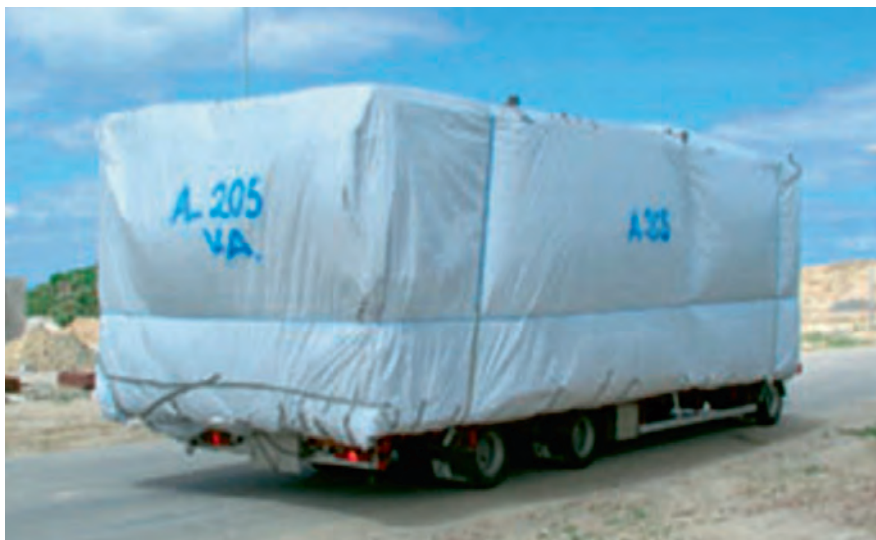
Рис. 11.1.21. Модуль, подготовленный для транспортировки на строительную площадку
