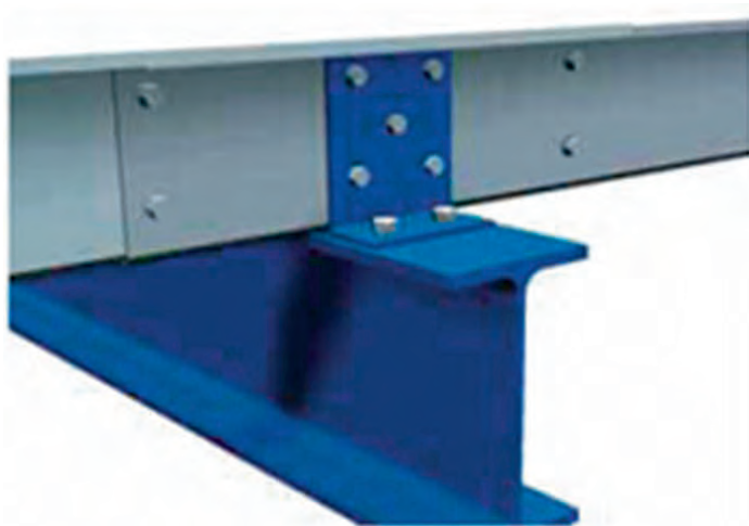
Рис. 10.2.3. Соединение Z-образного прогона на опоре внахлест [5]
