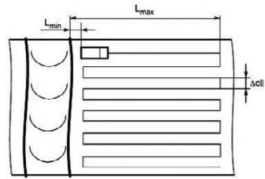
Рисунок 6 – Способ поперечно-продольного сканирования
