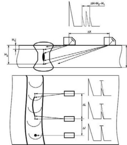
Рисунок 7 – Измерение условных размеров дефектов
