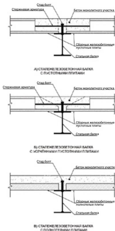
Рисунок 13. Варианты исполнения сталежелезобетонных балок со сборными плитами.
