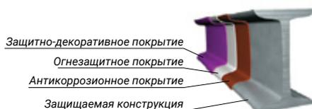
Рисунок 19. Двутавровая балка, покрытая вспучивающейся краской и покрывным составом.
