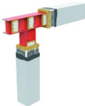
Рисунок 18. Огнезащита минераловатными плитами.
