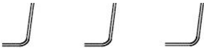
Рисунок 2 - Стенка профилей без элемента жесткости и стенки с элементами жесткости в количестве не более двух
