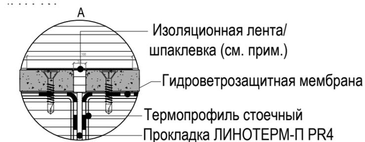
Рисунок Е5 - Расположение элементов стены (наружная облицовка, внутренняя облицовка, защитные мембраны, утеплитель, герметик) в месте вертикального стыка панелей.
