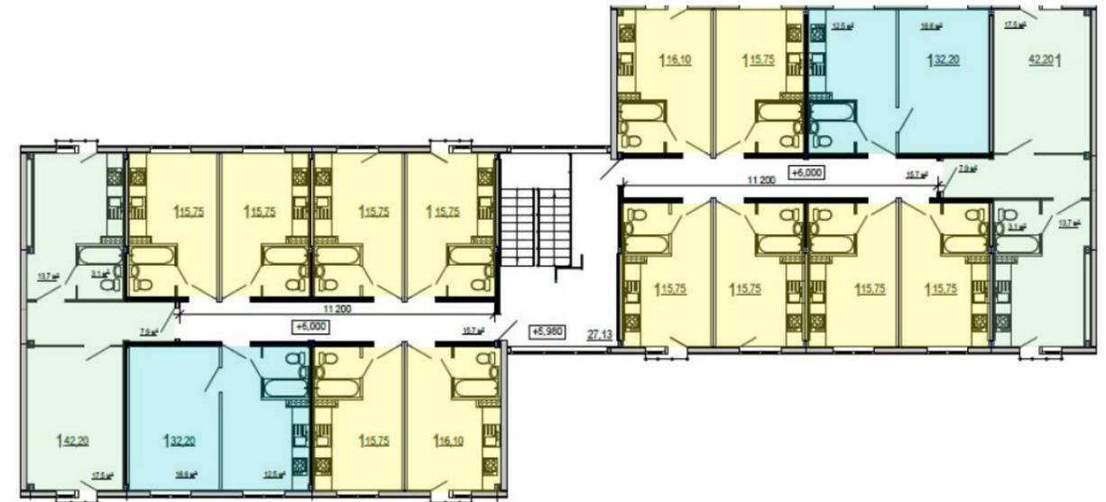
Рисунок А3 - План типового этажа жилого здания на 48 квартир
