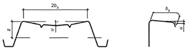
Рисунок 7.5 - Пример кривизны полки профиля, прямолинейного до приложения нагрузки
