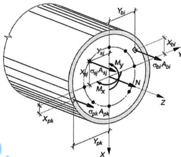
Рисунок 7.4 - Расчетная схема нормального сечения трубобетонного элемента
