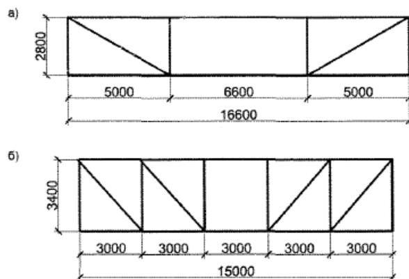
а) - схема фермы для общественного здания; б) - схема фермы для гаражей-стоянок
