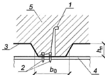
1 - угловой упор; 2 - дюбель; 3 - настил; 4 - опорная балка; 5 - бетон плиты
