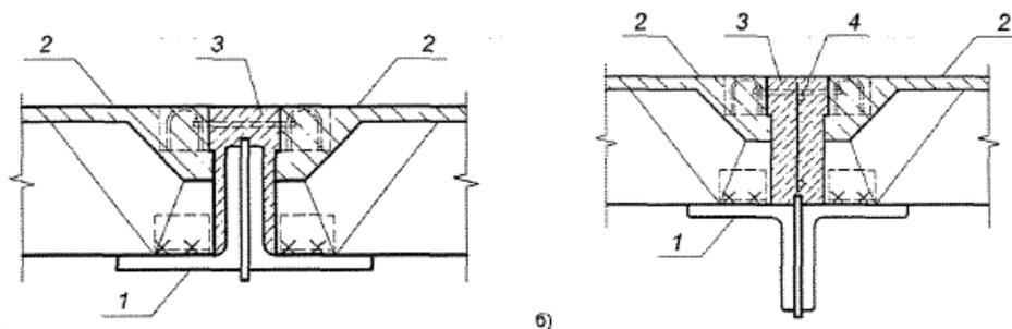
1 - пояс фермы; 2 - сборная железобетонная плита; 3 - бетон межплитного шва; 4 - армирование межплитного шва
