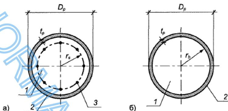
1 - бетонное ядро; 2 - труба; 3 - продольная стержневая арматура
