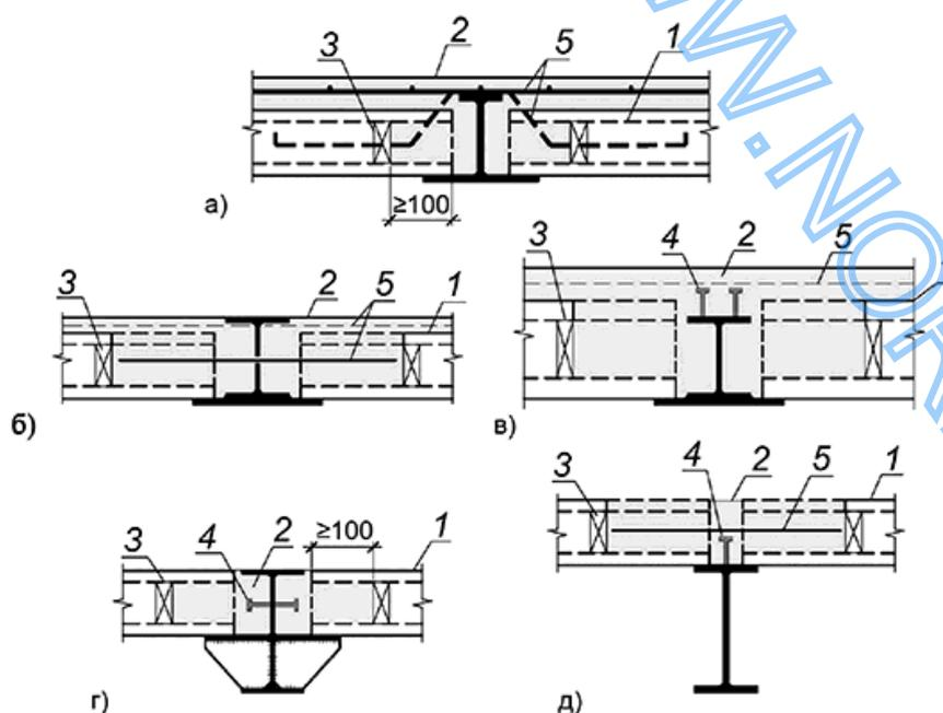
1 - сборная многпустотная плита перекрытия; 2 - монолитный бетон; 3 - заглушка; 4 - упор; 5 - арматурные стержни, сетки
