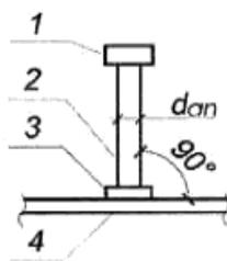
1 - головка упора; 2 - упор; 3 - сварка; 4 - стальной опорный элемент
