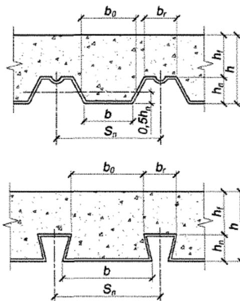
а) - стальной профилированный настил с гофром открытого типа; б) - стальной профилированный настил с гофром закрытого типа
