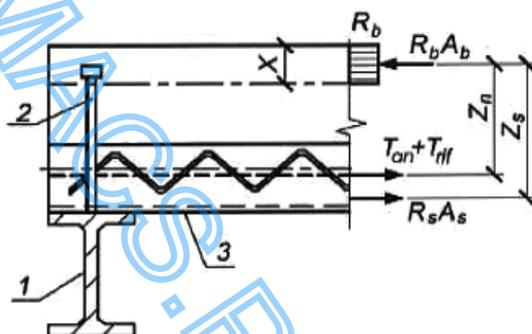
1 - прогон; 2 - упор; 3 - стальной профилированный настил
